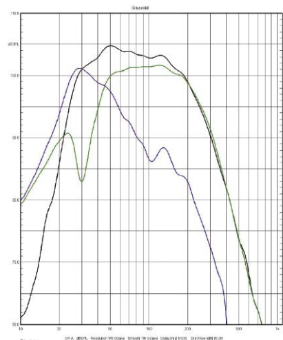
Rys. 5. GE1, charakterystyki źródeł niskich częstotliwości (poniżej 1 kHz, pomiar w polu bliskim).
